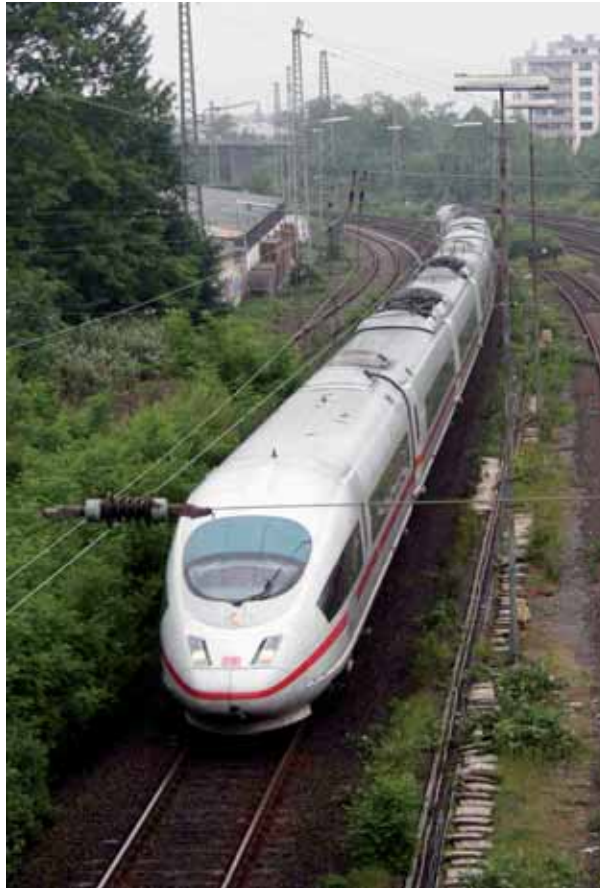
Auf's Dach geschaut: Die ICE 3M der Baureihe 406 besitzen sechs Stromabnehmer - und entsprechend auch sechs Windabweiser auf den Dächern. Die Aufnahme entstand am 15.06.2006 in Wesel. Foto: Dirk Übbing
